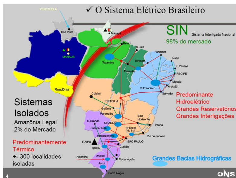
Figura 1 - Sistema Elétrico Brasileiro (SIN + Sistemas Isolados) Fonte: ONS
